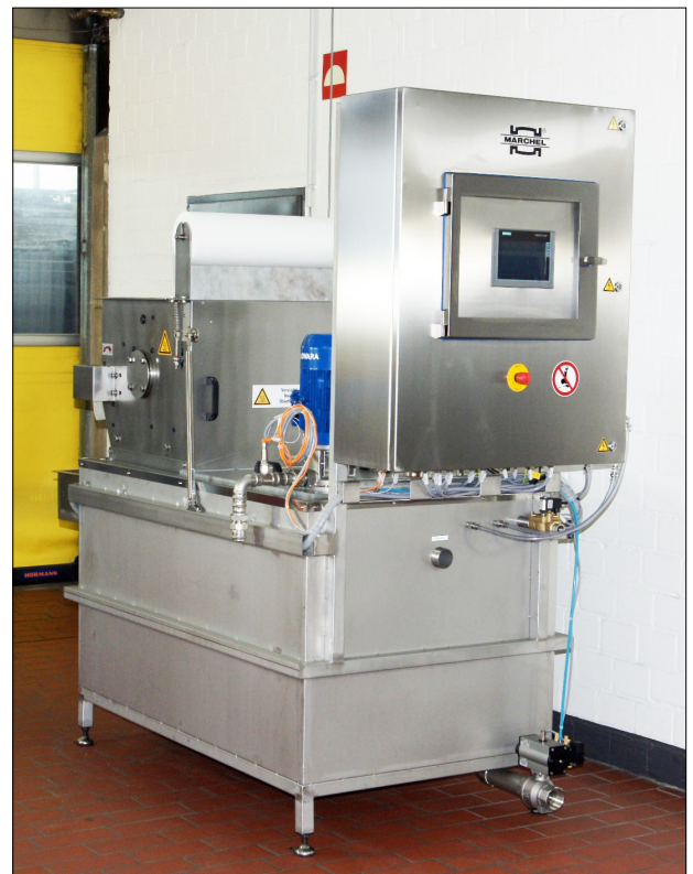
Ansicht einer Filtereinheit mit 550 Litern Brauchwasservolumen
